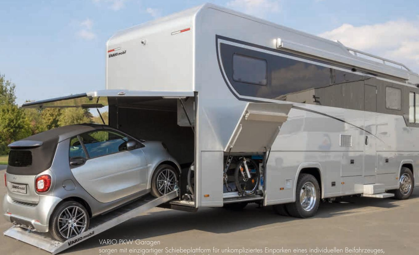
VARIO PKW Garagen sorgen mit einzigartiger Schiebepattform für unkompliziertes Einparken eines individuellen Beifahrzeuges, frei tragend, elektrisch oder hydraulisch für automatischen PKW-Einzug. Tragfähigkeit bis 1.700 kg. Optional ist die Heckklappe mit hydraulischer Betätigung und Funkfernbedienung ausgestattet, verdeckte innenliegende Scharniere sind dabei selbstverständlich. Seitlich integrierbar, und separat von der PKW-Plattform bedienbar, ist der zusätzliche „veloSLIDE“.
