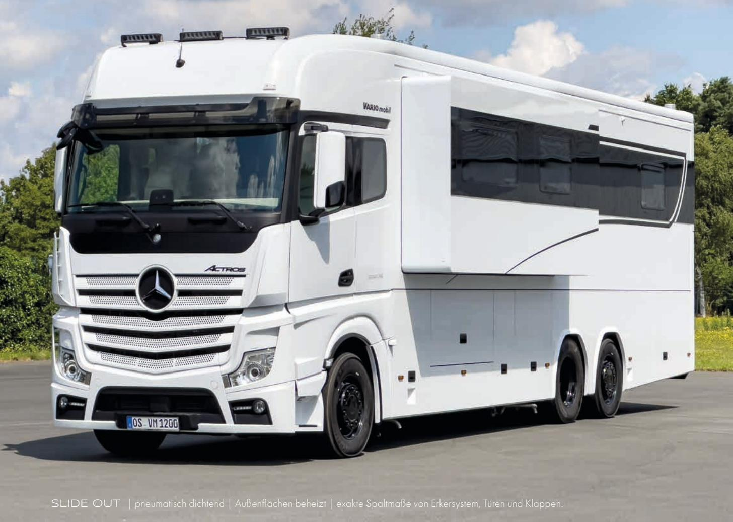
SLIDE OUT | pneumatisch dichtend | Außenflächen beheizt | exakte Spaltmaße von Erkersystem, Türen und Klappen.
